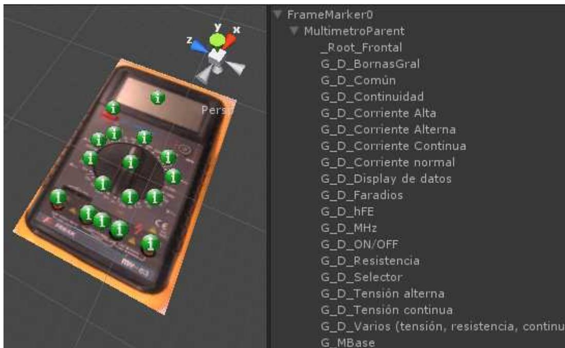
**Ilustración 39 - Puntos de referencia del frontal del multímetro.**
