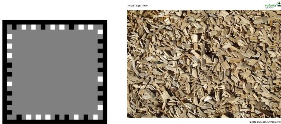
**Ilustración 36 - Ejemplo de marcador con identificador de Vuforia (izquierda) y marcador imagen con suficiente detalle (derecha).**
